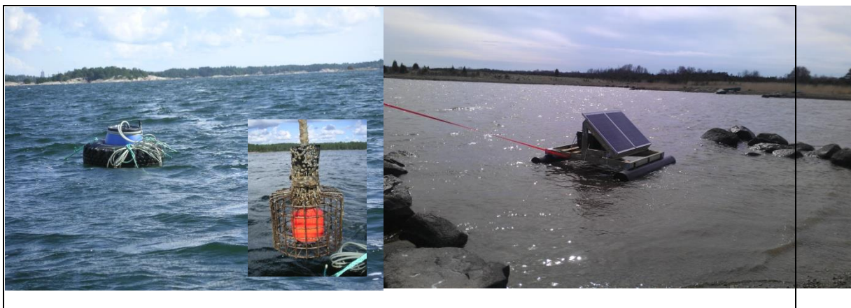
3. attēls. Roņu atbaidītāji jūrā (pa kreisi – darbināms ar akumulatoru, pa labi – ar saules baterijām)
