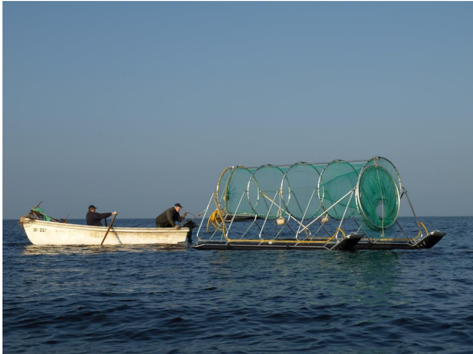
1. attēls. Roņu drošā murda āmis ar piepūšamiem pontoniem
