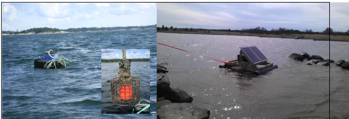
1.4. attēls. Roņu atbaidītāji jūrā (pa kreisi – darbināms ar akumulatoru, pa labi – ar saules baterijām).
