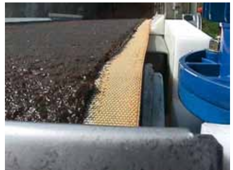
6.2. att. Lentes filtrs dūņu atūdeņošanai. Avots: Hydrotech
