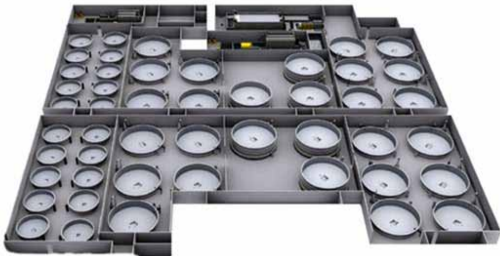
8.5. att. Akvakultūras lielsaimniecības shēma ar baseiniem (katra diametrs 15 m, tilpums vairāk nekā 500 m 3 ). Avots: AKVA group.
