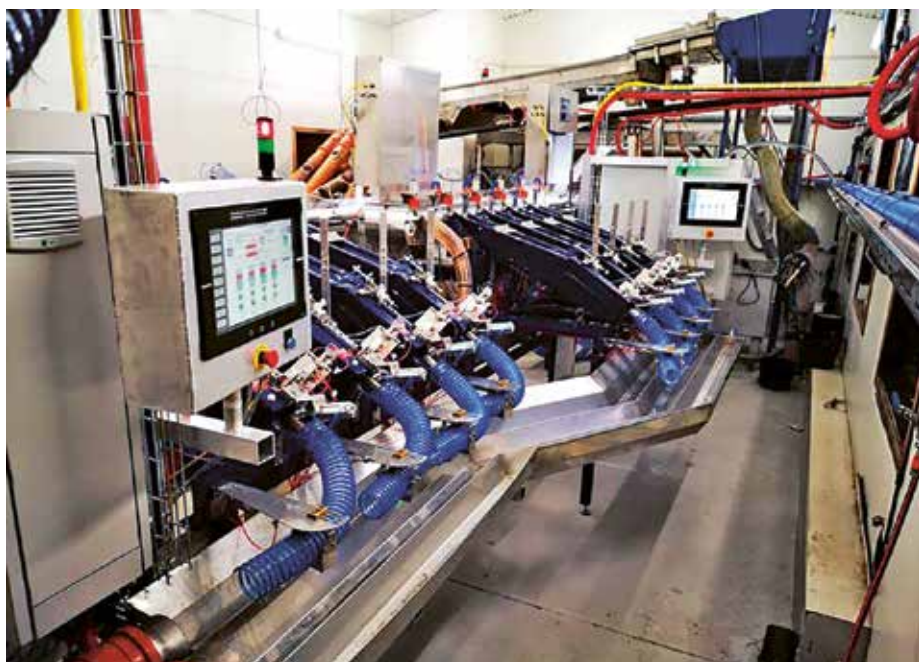
3. attēls. Pilnībā automātiska zivju vakcinācijas iekārta. Avots: "Lumic AS"
