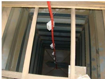
3.6. att. Caurules ar sensoriem novietojums graudu tvertnē.
