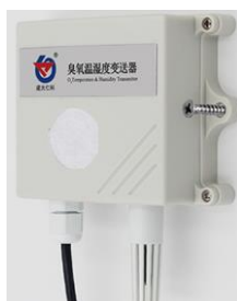
2.6. att. RH, T° un O 3 sensoru sistēma RS-O3WS-N01-2-4-10, kas tiek testēta darbam graudu tvertnē.
