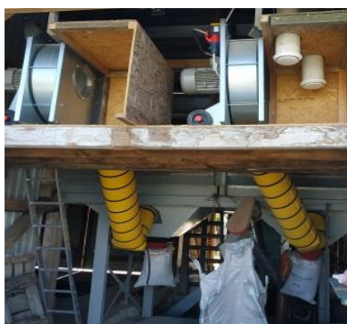
3.2. att. Platforma ar uzstādītiem ventilatoriem un ozona padeves caurulēm.
