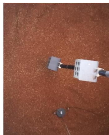
4.3. att. Sensoru kārbas un caurule ozona koncentrācijas kontrolei.
