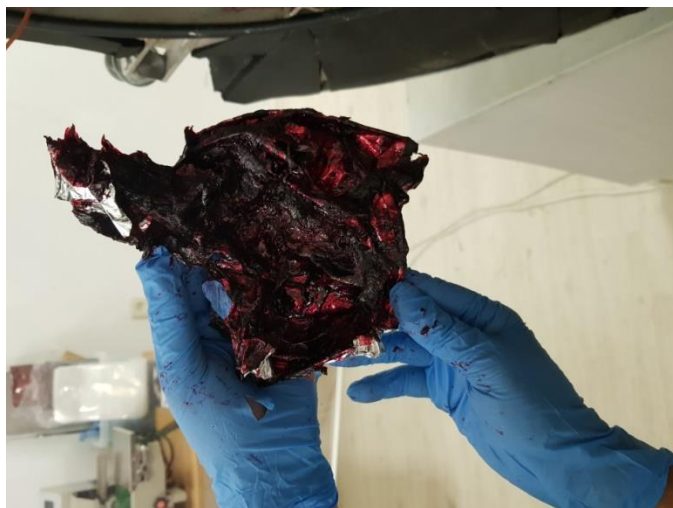
Vārīšanās procesā, no upeņu sīrupa cikla beigās pārpalikums, kas pilnībā piekusis pie trauka un vakumkameras plaukta.
