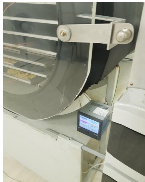
Vakuuma kameras durvis, sublimācijas laikā
