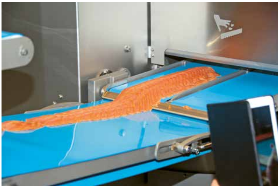
Automātiskās griešanas mašīnas ir programmētas tā, lai fileju sagrieztu ļoti precīzi dažu sekunžu laikā. Iekārta automātiski pielāgojas filejas izmēram un formai, lai nodrošinātu vislabāko iznākumu. Foto: no Marel
