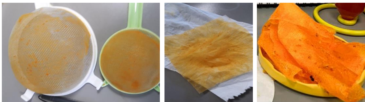
2.2.3.attēls. Sieti un filtraudums šķidruma atdalīšanai pēc smiltsērķšķu ogu atūdeņošanas ar spirtu.
