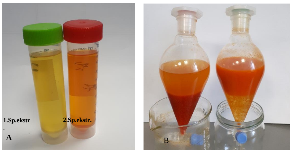
2.3.4. attēls. Spirta ekstrakts pēc pirmās un otrās atūdeņošanas (A), spirta/eļļas ekstrakts (B).
