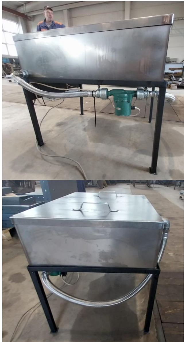
10.5. attēls. Izgatavotā kaņepju šķiedras balināšanas iekārta
