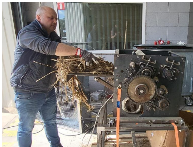
9.28.attēls. Mākslīgi tilināto stiebru dekortikācija laboratoriskajā iekārtā
