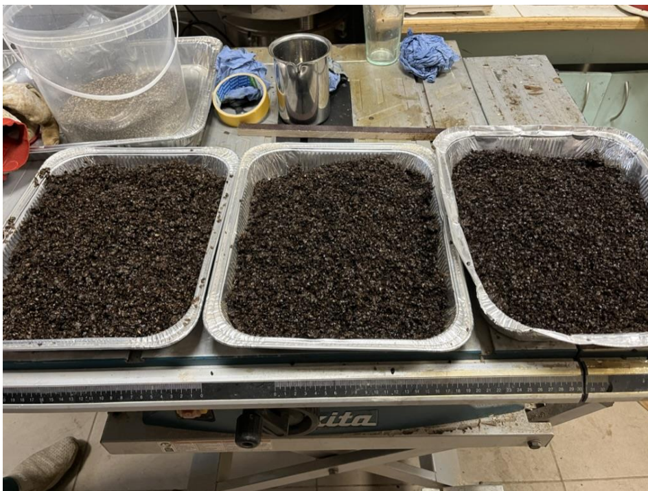
12.5. attēls. Kaņepju čauliņas pēc apstrādes tvaika sprādziena iekārtā.
