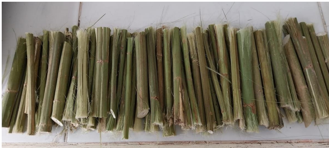
9.7.attēls. Sagarumoti kaņepju stiebi tilināšanas tehnoloģijas aprobācijai laboratorijas mērogā
