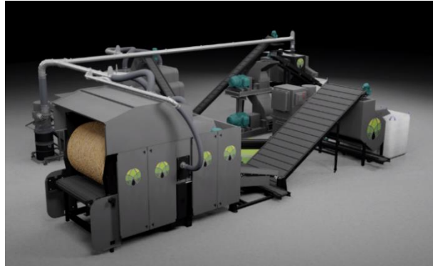
3.4. attēls. Kaņepju dekortikācijas iekārta Fiber Track 660 [48]
