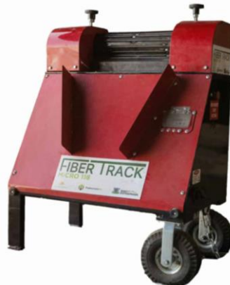
3.3. attēls. Mazjaudas dekortikators FiberTrack 118 [47]
