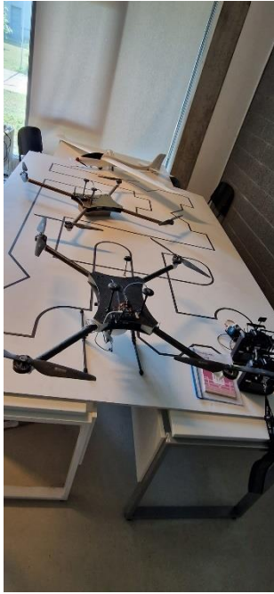
13.15. attēls. Droni, kas izgatavoti no kaņepes saturošs kompozītmateriāla
