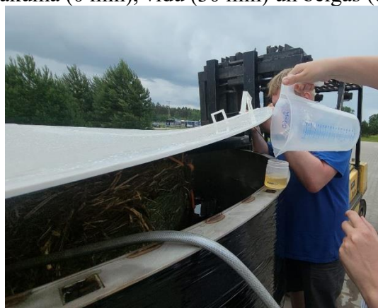
9.27.attēls. Paraugu ņemšana pH, elektrovadītspējas un izšķīdušā skābekļa daudzuma noteikšanai
