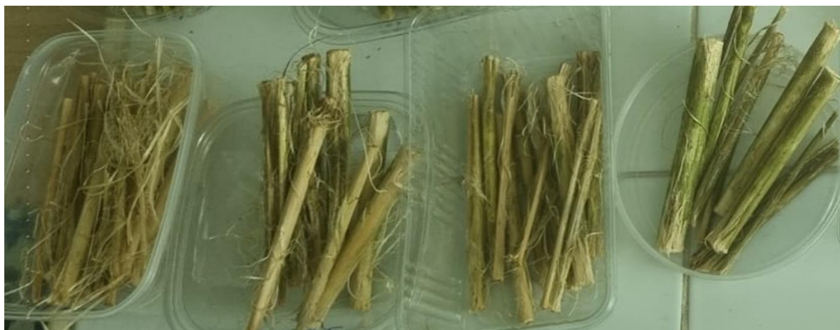
9.17.attēls. Šķiedru atdalīšanās no kaņepju stiebriem pēc 1h apstrādes 0,5-1% NaOH šķīdumā >80°C temperatūrā
