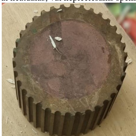
9.13.attēls. Rievots metāla rullis šķiedru stiebru dekortikācijas imitēšanai
