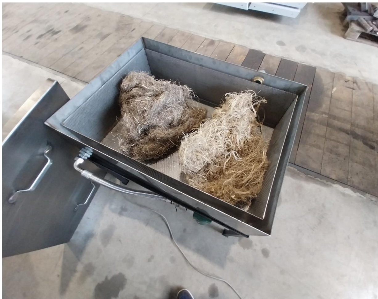
10.6. attēls. Kaņepju šķiedru balināšanas iekārta
