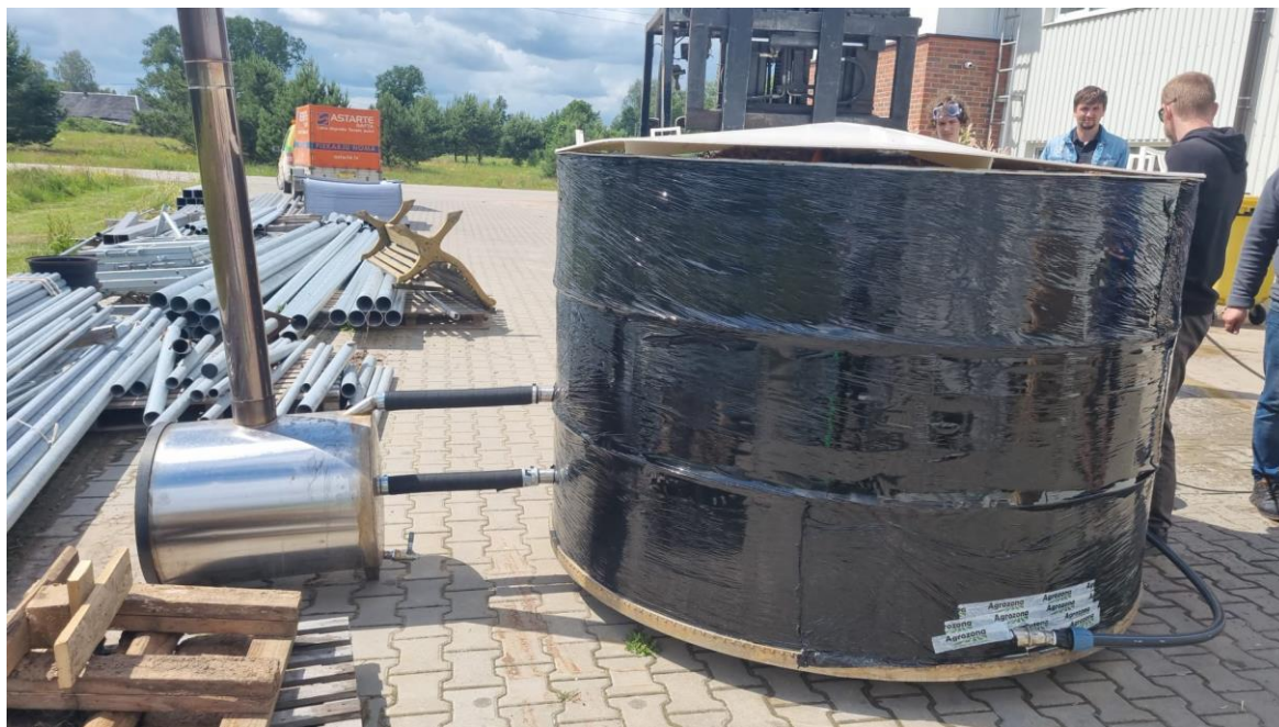
9.24.attēls. Pilotmēroga tilināšanas tehnoloģijas aprobācijā izmantotā SIA “Agrozona” izstrādātā mākslīgās tilināšanas iekārta (hidrotermiskā tvertne)
