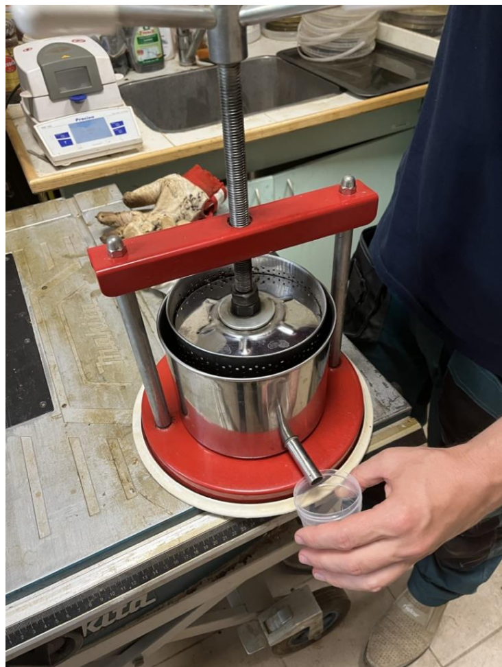
12.4. attēls. Prese ekstrakta atdalīšanai no biomasas.
