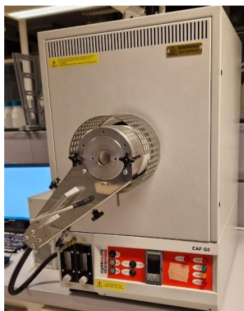
13.8. attēls. Rēzeknes Tehnoloģiju akadēmijā esošais Carbolite Gero pelnu kušanas temperatūras noteikšanas iekārta
