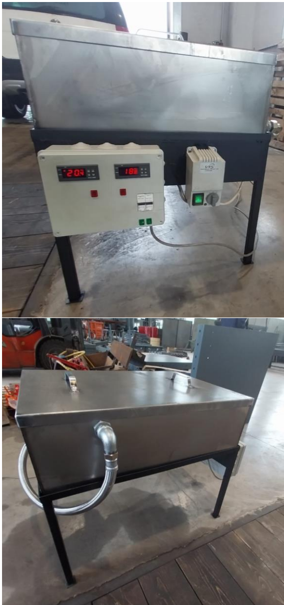
10.5. attēls. Izgatavotā kaņepju šķiedras balināšanas iekārta
