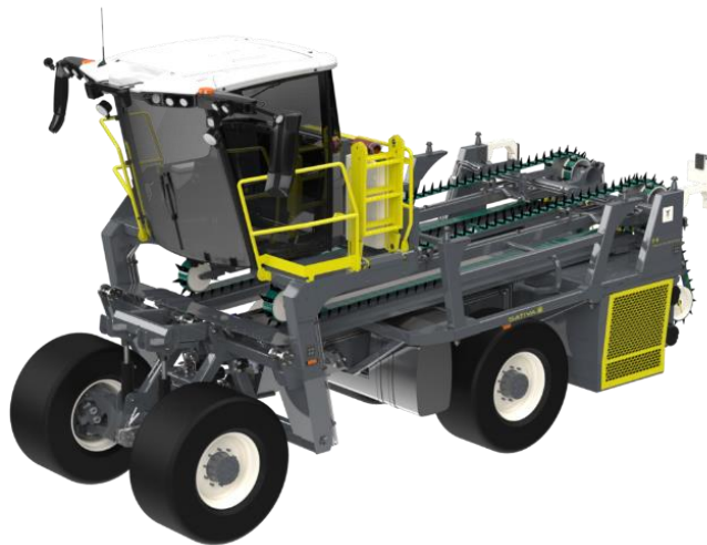
2.2. attēls. Linu/kaņepju novākšanas kombains novākšanai
