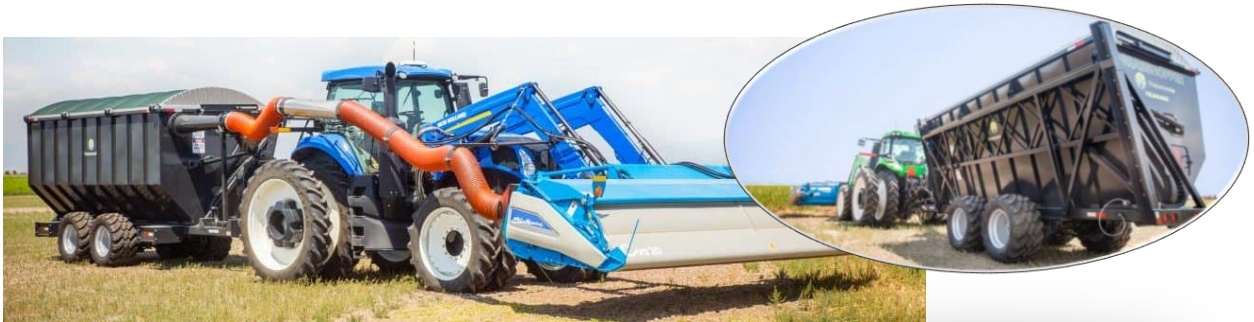
2.6. attēls. Clean Strip Bud Stripping kaņepju novākšanas agregāts [41 a]
