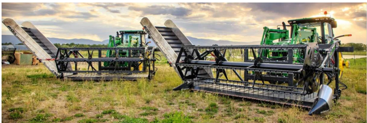
2.5. attēls. Uz frontālā iekrāvēja uzkarināms kaņepju pļaušanas heders, modelis CleanCut
