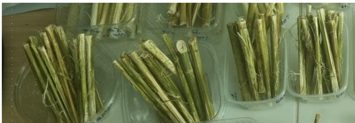
9.18.attēls. Šķiedru atdalīšanās no kaņepju stiebriem pēc 1h apstrādes 0,5-1% Na 2 CO 3 šķīdumā >80°C temperatūrā
