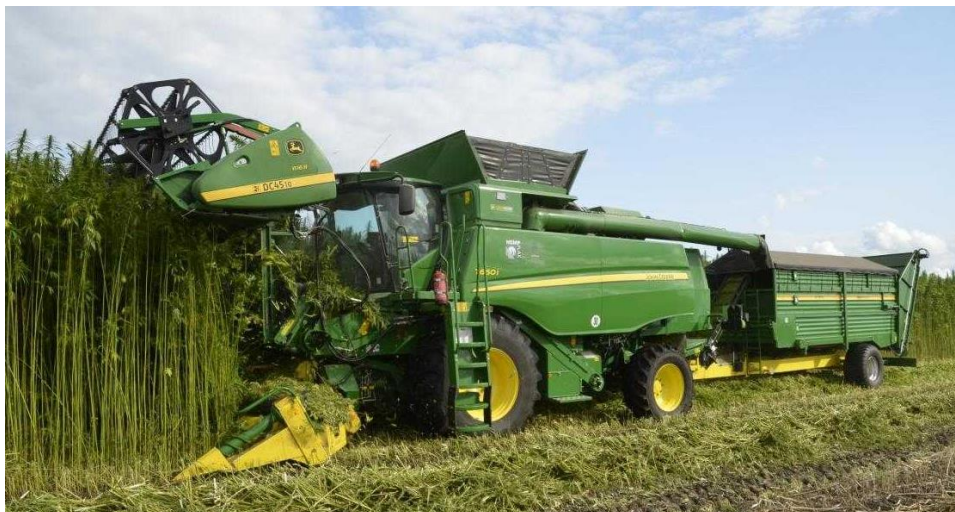
2.7. attēls. Kaņepju novākšanas kombains, modelis John Deere T660i
