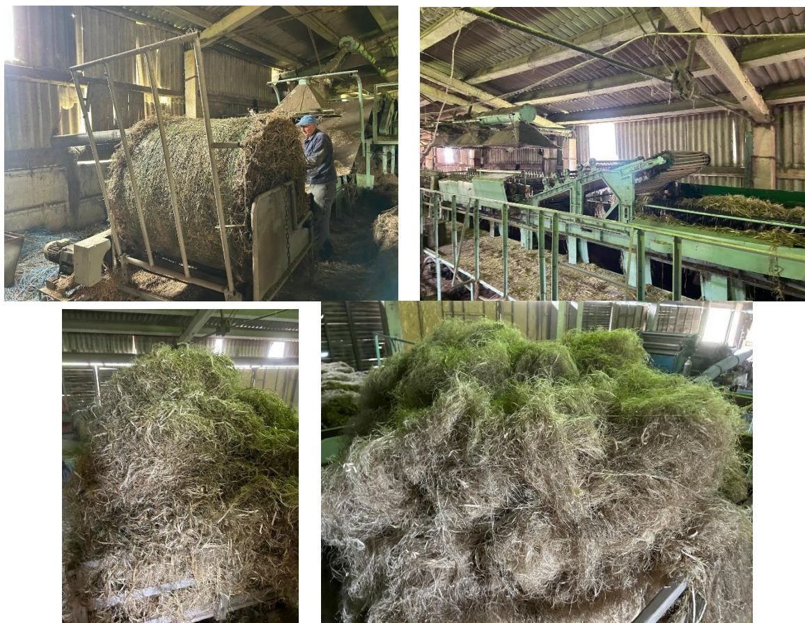
6.52. attēls Kaņepju stiebru dekortikācija un iegūtā šķiedra
