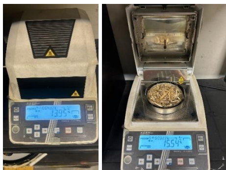
6.49. attēls. Kaņepju stiebru mitruma noteikšana
