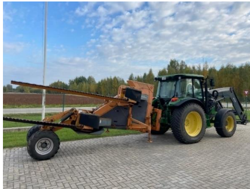
6.22. attēls. Divu līmeņu segmenta tipa pļaujmašīna
