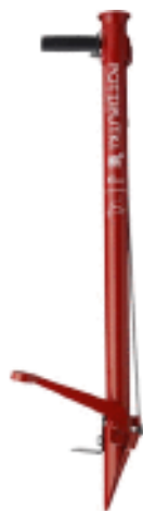
10. attēls. Mežu stādāmais stobrs, kas izmantots ķiploku stādīšanai.
