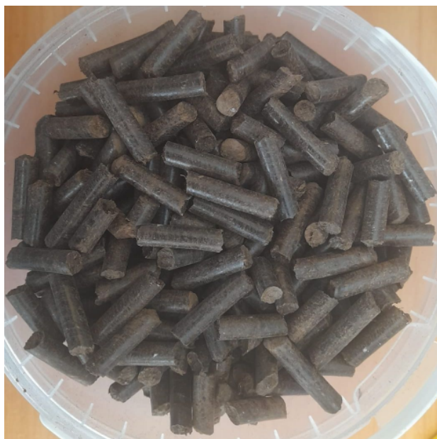
6.e. attēls. Granulas no biomasas smalkās frakcijas.
