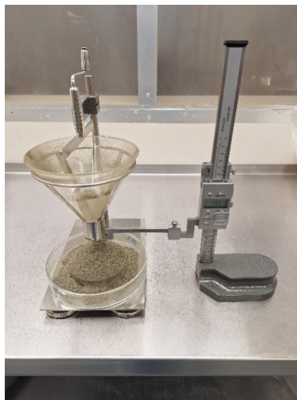
2. c' attēls. Nobiruma leņķa noteikšanas ierīce.
