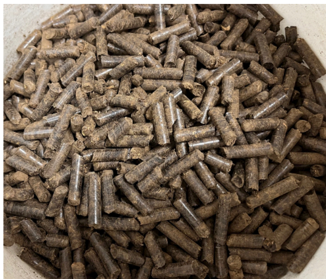
4.e.att. Granulas no skuju materiāla ar 14% mitrumu – vizuāli labākais variants.
