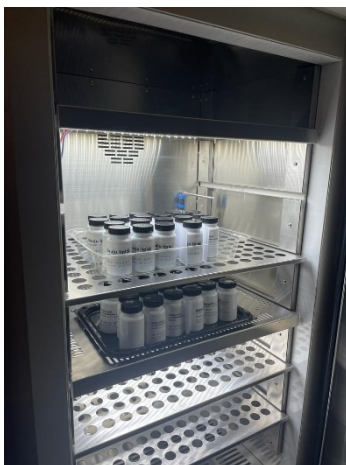
7 c'. attēls. Paraugu uzglabāšana klimata kamerā stabilitātes izpētei.
