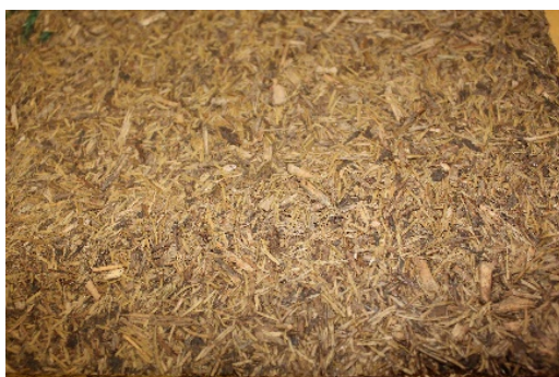
1.b.att. Pēc ekstrakcijas skuju rupjās frakcijas plātne (visā biezumā).
