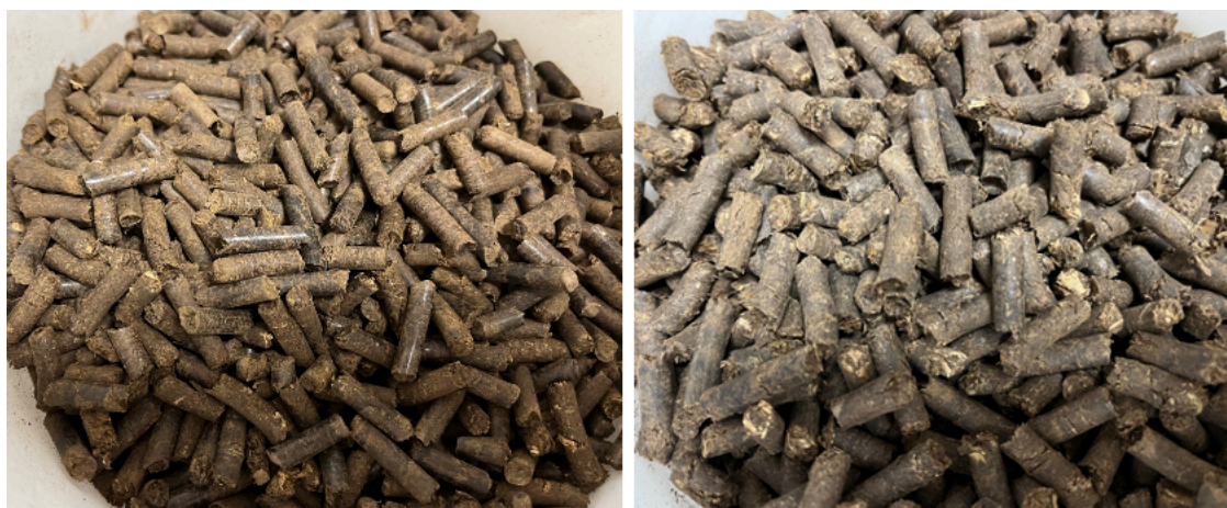
2.e.att. Dažāda mitruma skuju biomasas granulēšana ar vienādu granulēšanas ātrumu, matrica.
