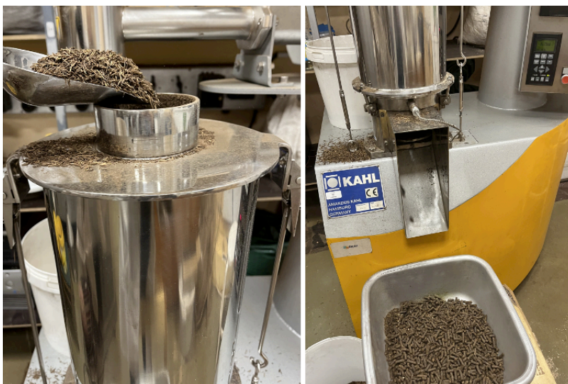
2.e.att. Dažāda mitruma skuju biomasas granulēšana ar vienādu granulēšanas ātrumu, matrica.
