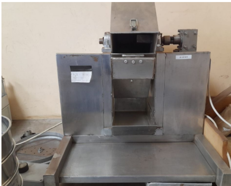
7.e. attēls. Aparāts nodilumizturības noteikšanai.
