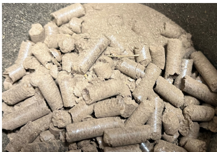
1.e.attēls. Granulas no izsijāta skuju materiāla ar 8,5 \pm 0,5\% mitrumu
