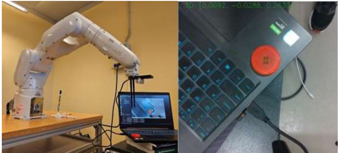
Att. 0-9. Robota pozicionēšanas testēšana izmantojot sarkano marķieri.
