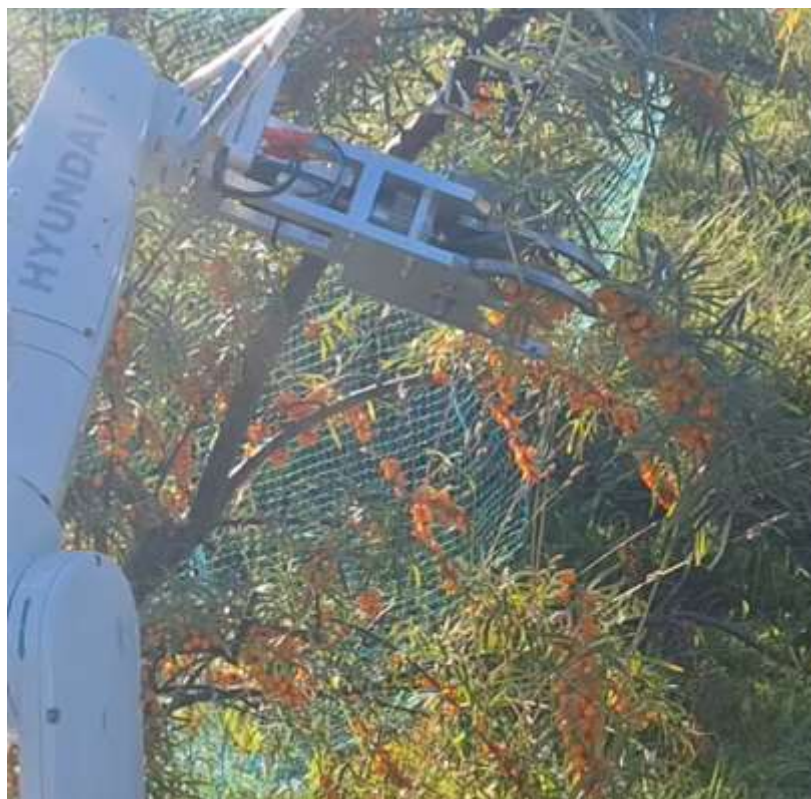
Att. 3-25. Kustības, satveršanas un griešanas process
