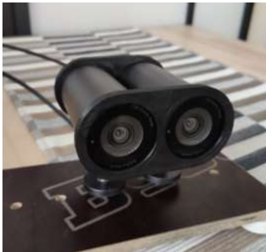
Att. 0-1. Datorredzes (CV) sensora makets un izmantotā testa stereo kamera.
