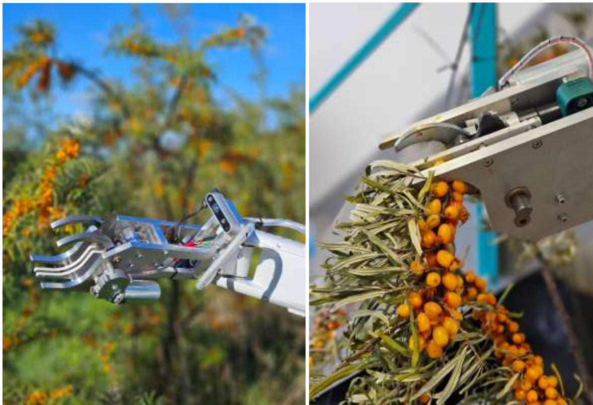
Att. 0-40. Agrobots satvērēja/griezēja mehānisma testēšana.
