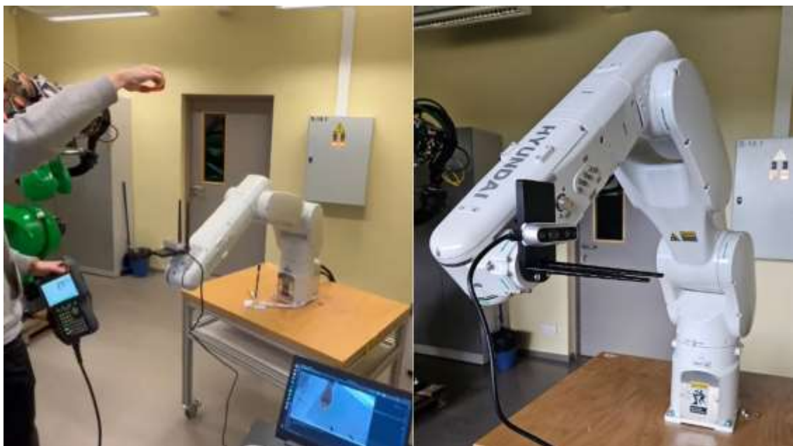
Att. 0-10. Robota pozicionēšanas un rotācijas testēšana
