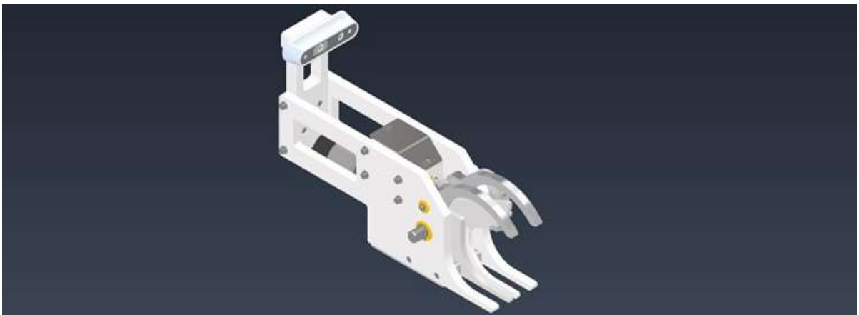
Att. 0-24. Griezējmehānisms ar CV kameras integrāciju
