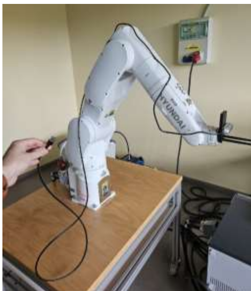
Att. 0-12. USB kabelis, kas strādā ar Inter Realsense D435i kameru, 3 metri.
