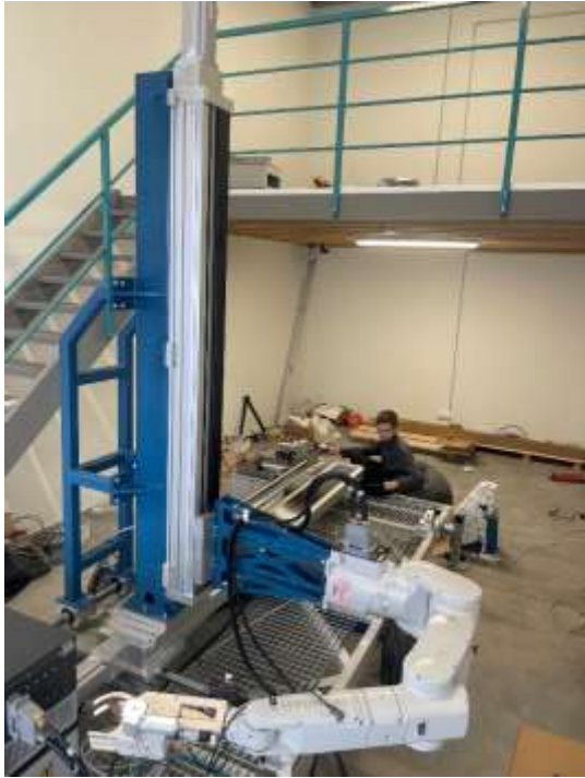
Att. 0-20. Uzlabotās versijas risinājuma 3 asu montāža un testēšanas process.
