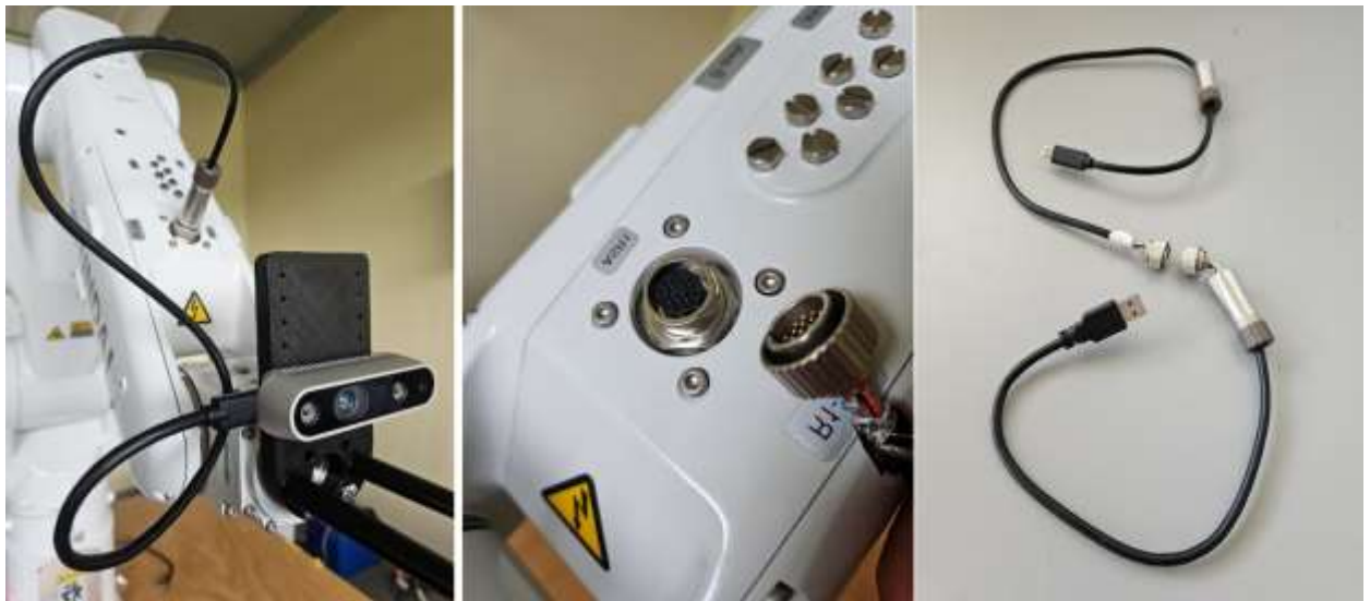
Att. 0-11. USB kabelis ar paštaisītu konektoru izmanto vadu kas jau ir manipulatorā.
