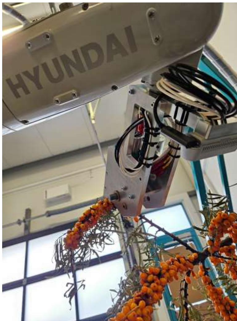
Att. 0-33. Zara griešanas algoritma testi LATMAS telpās.
