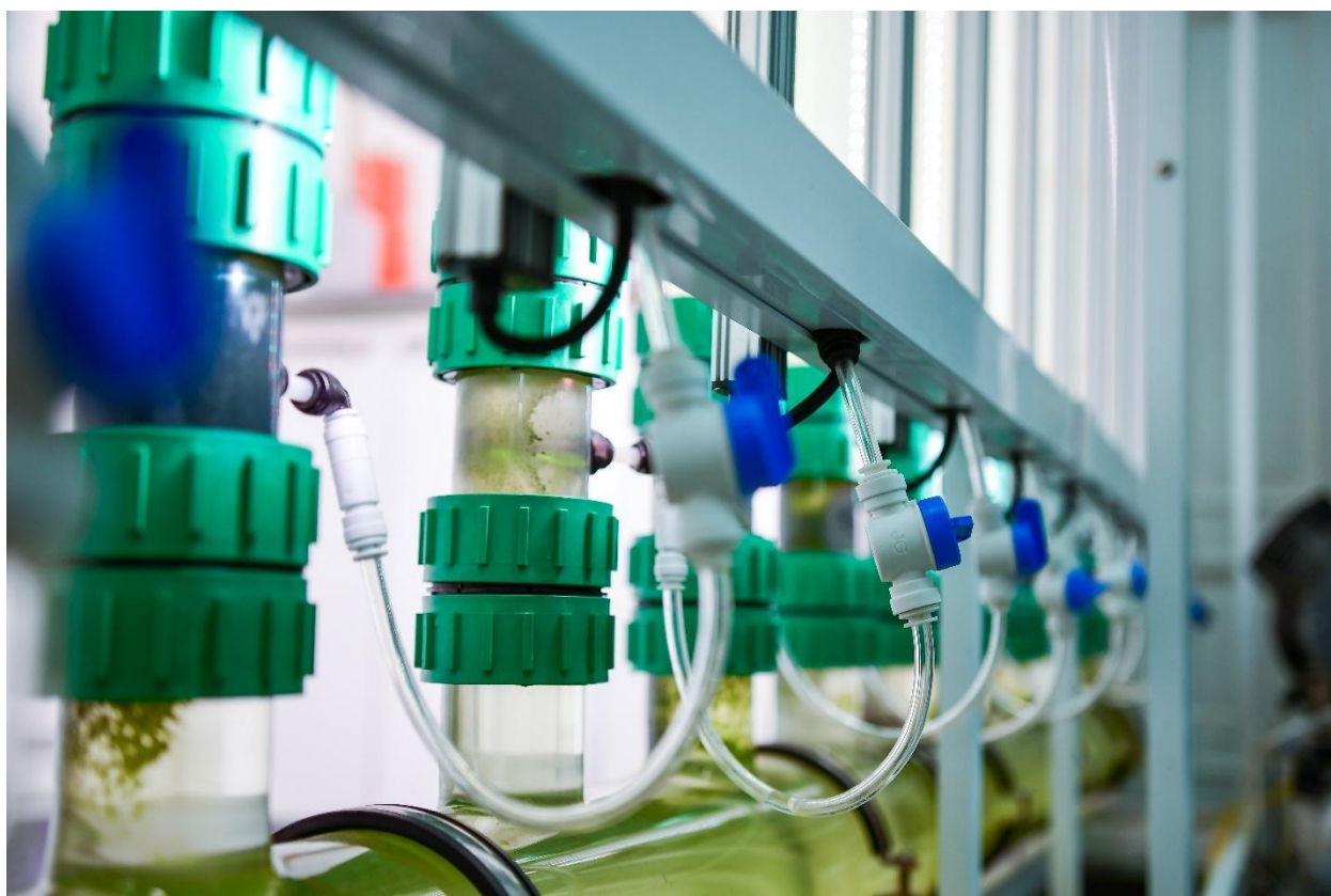
7.2.4.5. attēls. Mikroaļģu kultivēšana fotobioreaktorā ar iepriekš optimizētiem augšanas apstākļiem.
