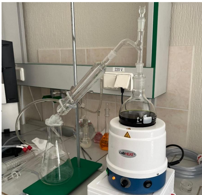
10.2. attēls. Šķīdinātāja (etanola) vakuumdestilācija procesā.
