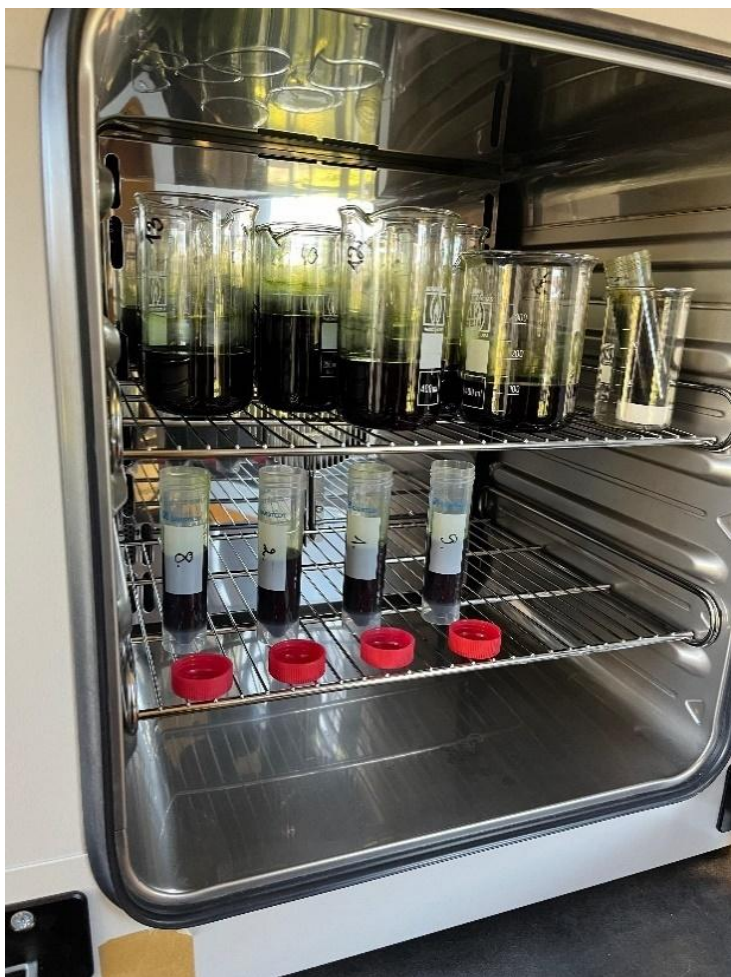
10.16. attēls. Šķīdinātāja tvaicēšana žāvskapī.
