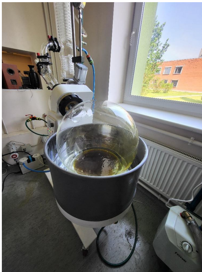
11.4. attēls. Etilspirta atdalīšana (atgūšana) no mikroaļģu lipīdiem (K. Spalvis foto).
