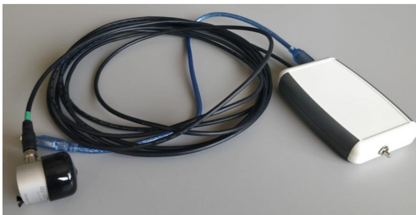
Attēls 1-38. Izstrādātais portatīvais PAR sensora modulis
