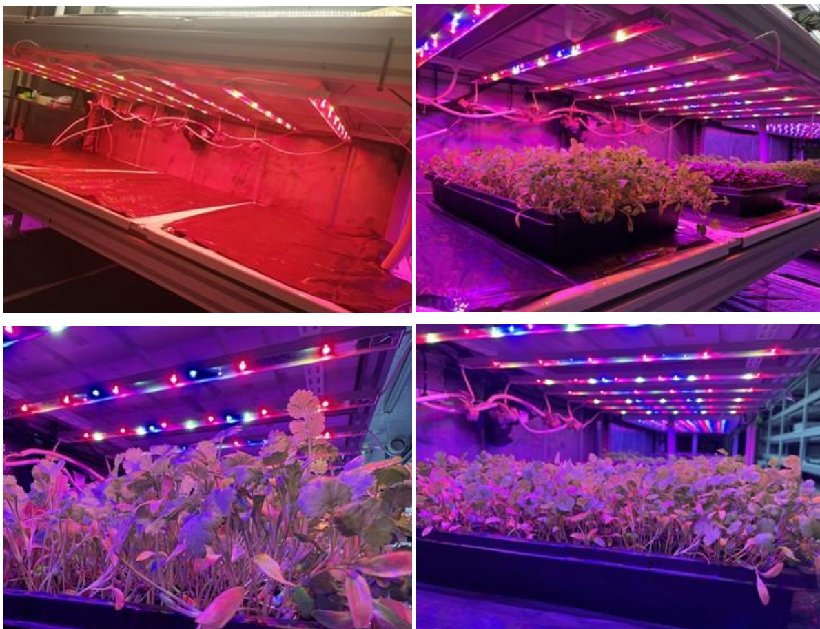
7.1. att. DC-LED gaismekļu sistēmas testi reālistiskā (vertikālās audzēšanas konteineru) vidē.
