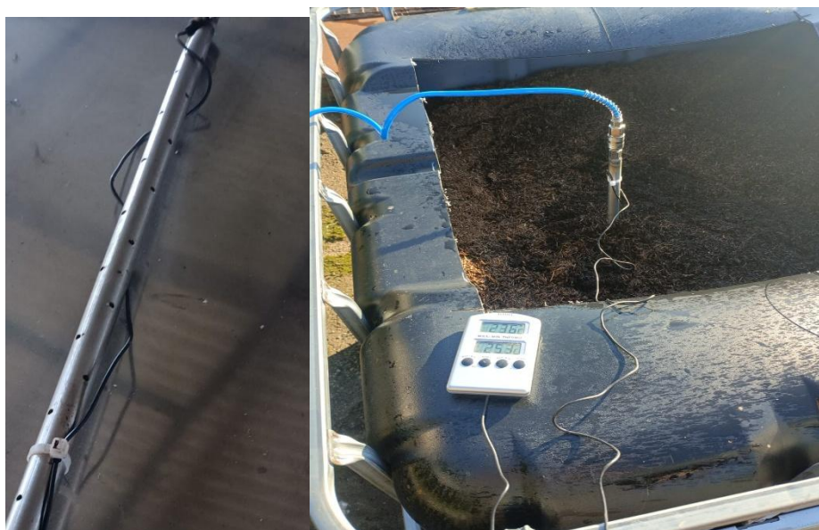
7.27. att. A – Aerācijas stienis; B - Aerēšanas un temperatūras uzmērīšana
