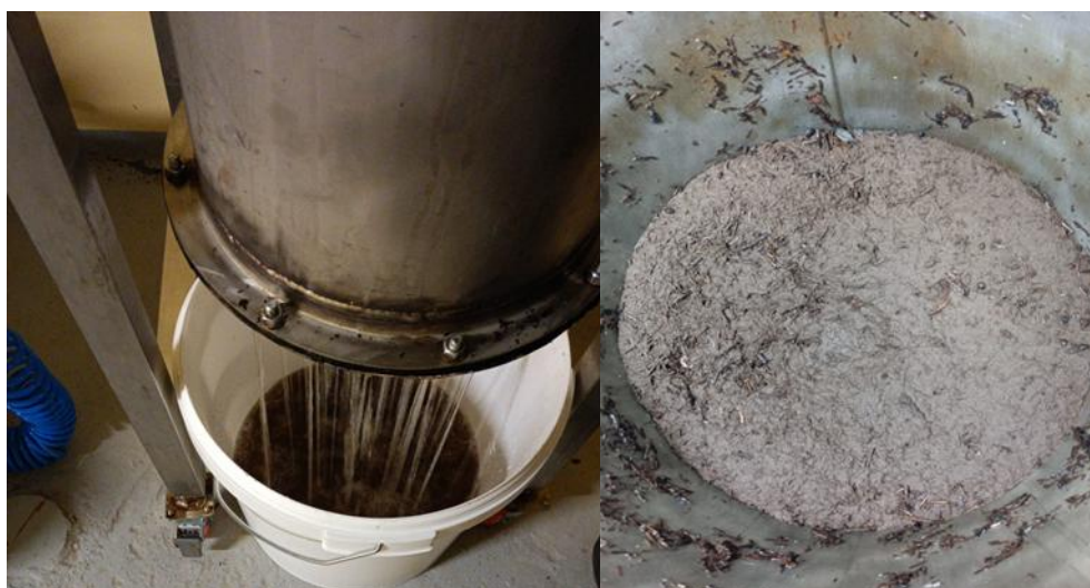
7.33. att. A- Ekstrakcijas process. Šķidrā frakcija; B - Sausais atlikums ekstraktorā
