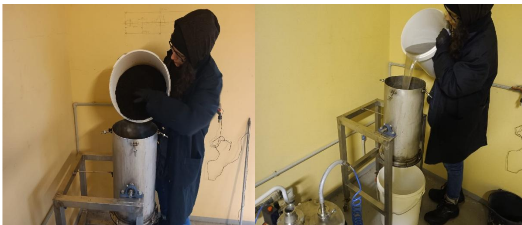
7.32. att. A - Ekstraktora pildīšana ar substrātu; B - Šķīdinātāja pievienošana
